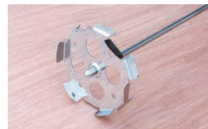
攪拌機 1,300rpm リシン羽根
